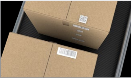
包裝之間的短空隙增加了均勻照明的難度
